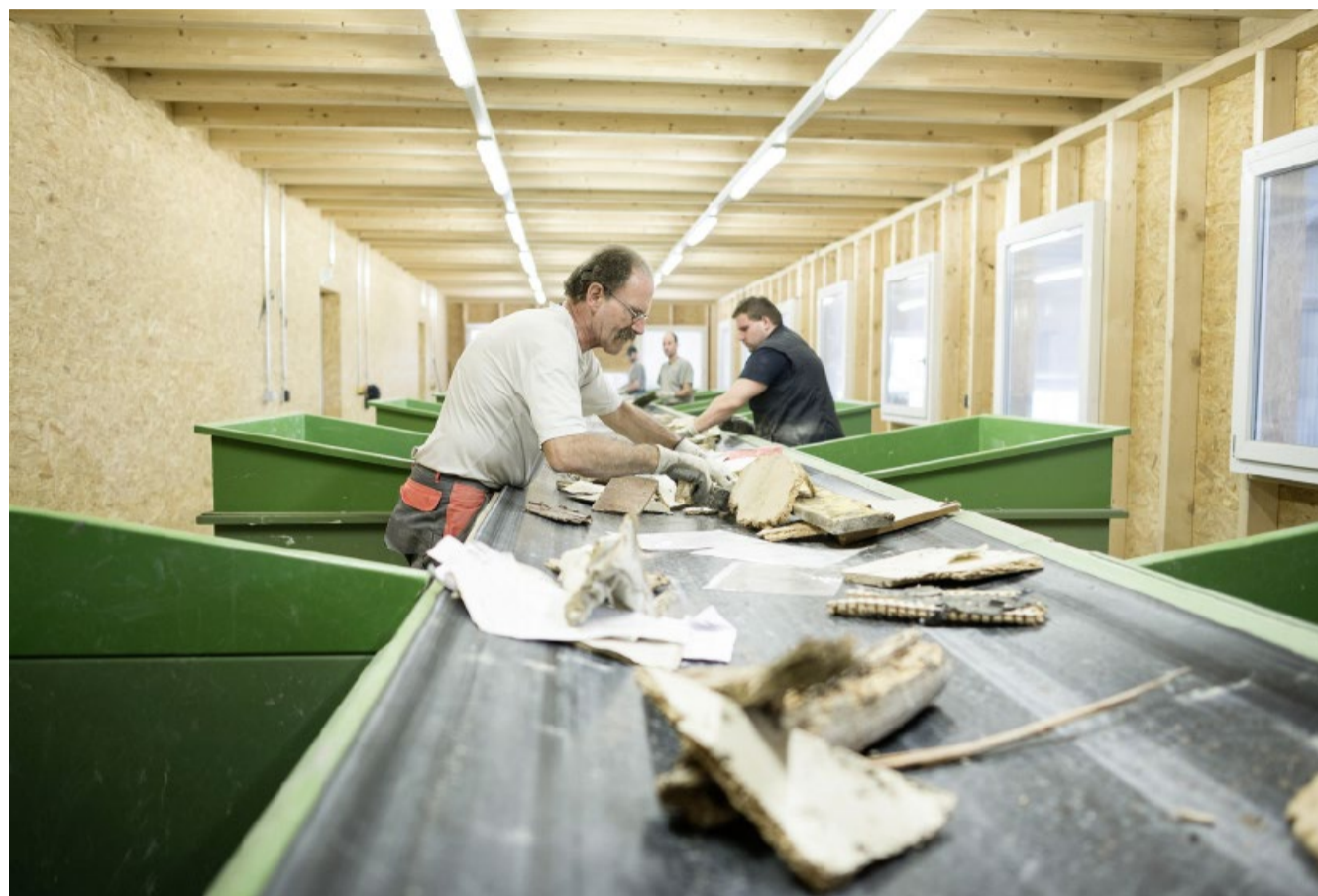
Am Sortierband wird der Abfall in flinker Handarbeit verlesen und in die passenden Sammelbehälter geworfen.
